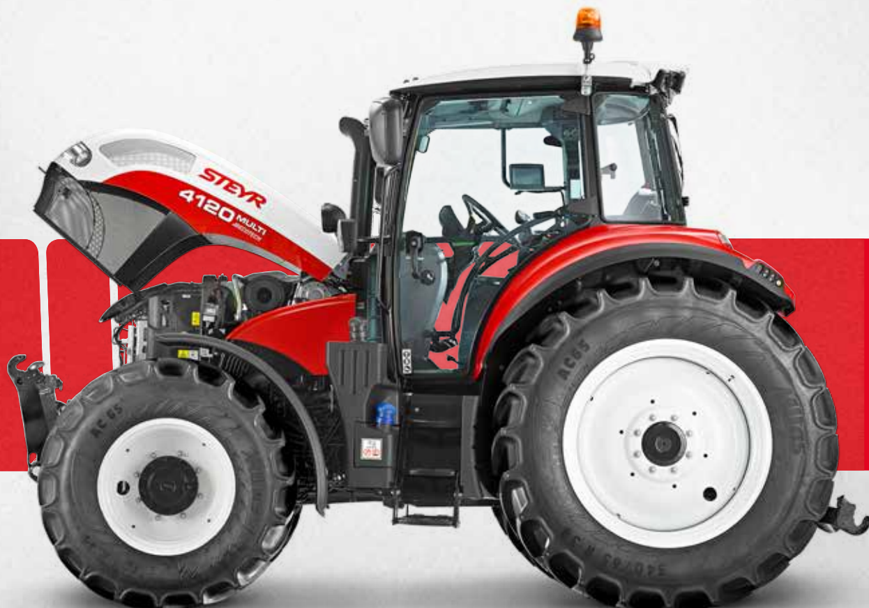
Ciągłe czyszczenie za pomocą filtra Piclon dba o to, aby filtr musiał być konserwowany tylko wtedy, gdy zaświeci się odpowiednia lampka ostrzegawcza.
