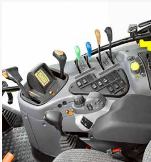
Profi Classic z mechanicznymi zaworami hydrauliki zewnętrznej i elektronicznym układem regulacji zaczepu (EDC).
