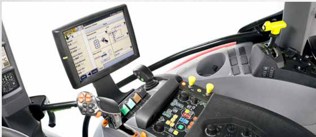
Profi i Profi CVT posiadają maksymalnie cztery elektryczne zawory hydrauliki zewnętrznej.
