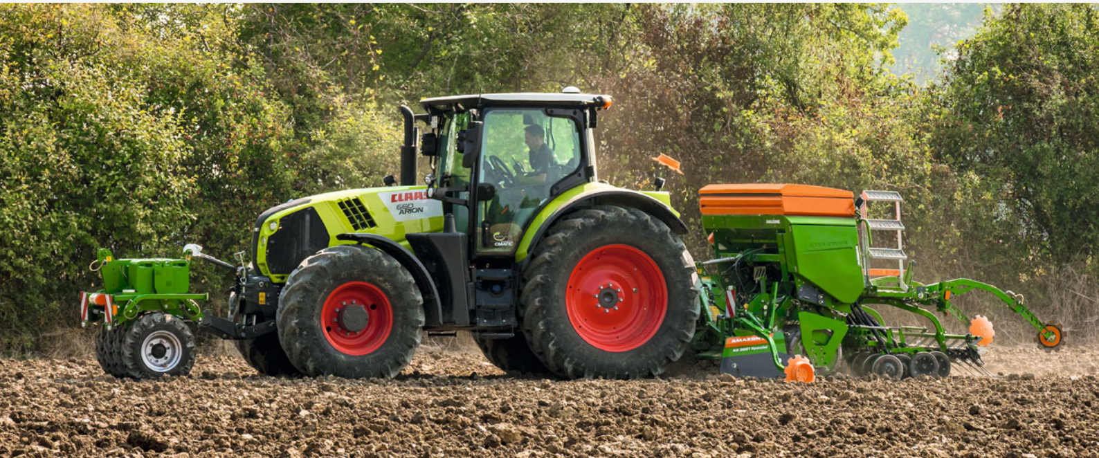
Cataya 3000 Super z wałem oponowym T-Pack U do siewu po orce
