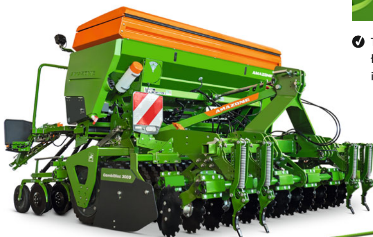
Kompaktowa brona talerzowa CombiDisc 3000 z siewnikiem nabudowanym Cataya 3000 Super
