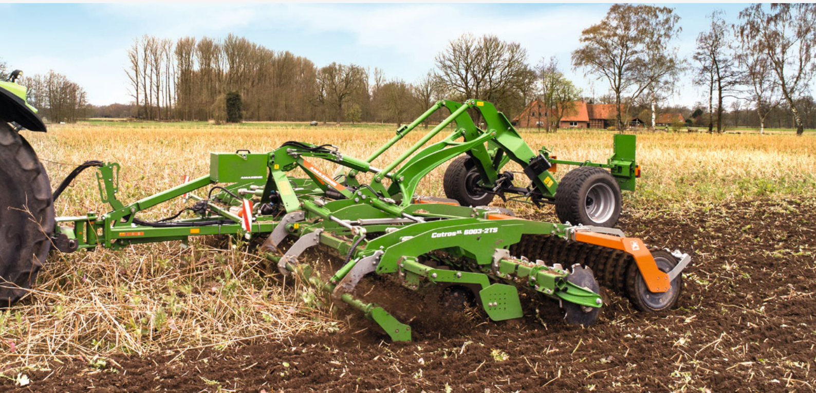
Catros XL 6003-2TS podczas zrywania ścierniska
