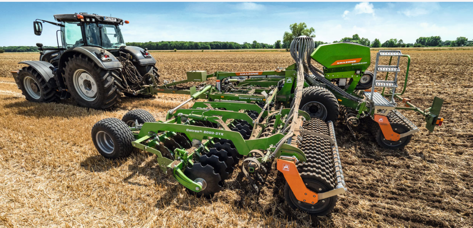
Catros XL 8003-2TX przy zrywaniu ścierniska z zamontowanym GreenDrill do uprawy poplonów
