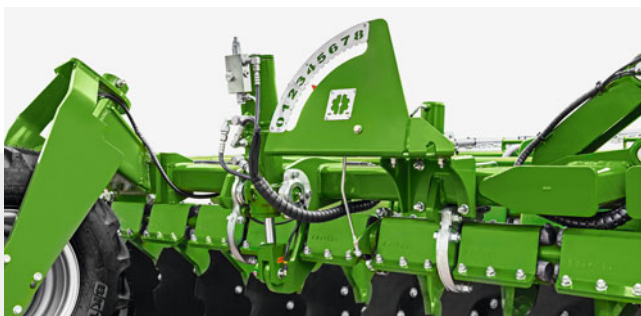
Hydrauliczna regulacja głębokości roboczej z czytelną skalą
