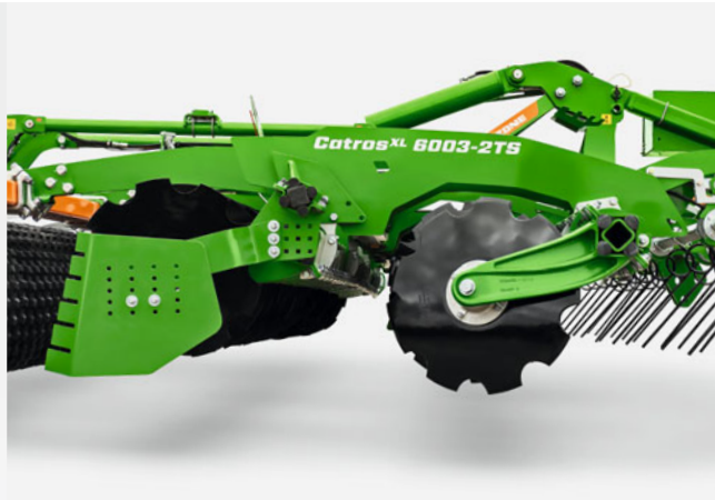
Catros XL 6003-2TS na najmniejszej głębokości roboczej – talerze są całkowicie zbliżone do ramy
