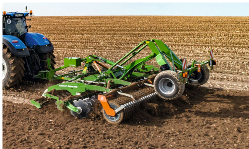
Catros XL 6003-2TS z przednim wałem nożowym
