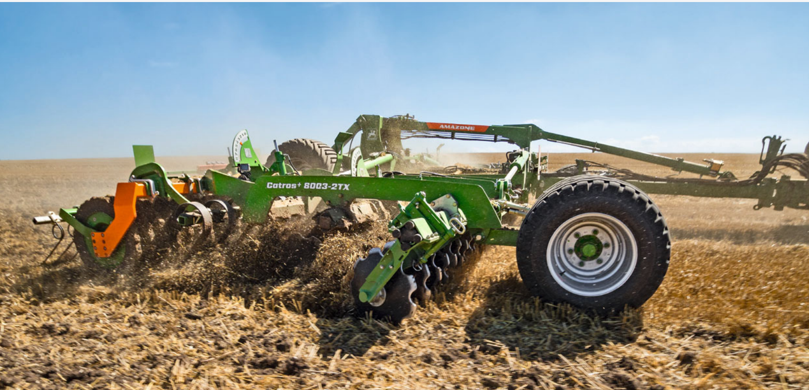
Catros + 8003-2TS podczas zrywania ścierniska
