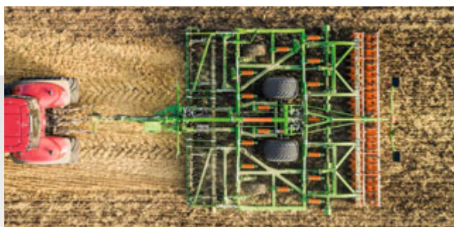
Za każdym kołem znajduje się ząb do spulchniania śladów po kołach
