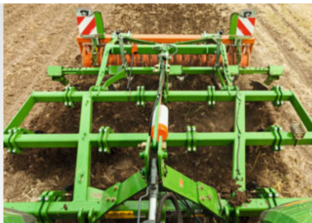
3-belkowa konstrukcja ramy Cenius 3003 Special
