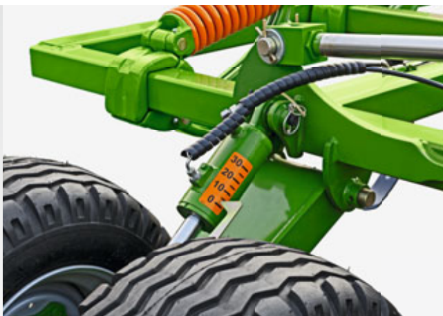
Skala hydraulicznej regulacji głębokości roboczej pola zębów
