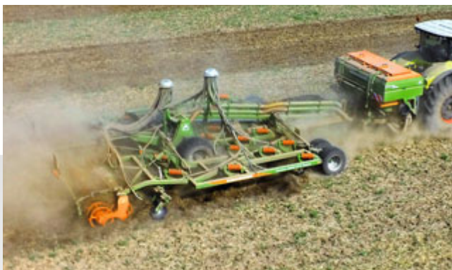
XTender 4200 z Ceniuss 6003-2TX i dwoma układami transportowymi do aplikacji nawozu i materiału siewnego
