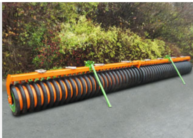
❗ „Przykręcane klamry pozwalają bardzo łatwo demontować wał przed pracą na mokrych polach lub po orce „przedzimowej” (praktyczne testy pracy AMAZONE Cenius 5003-2TX Super · 3/2016)
