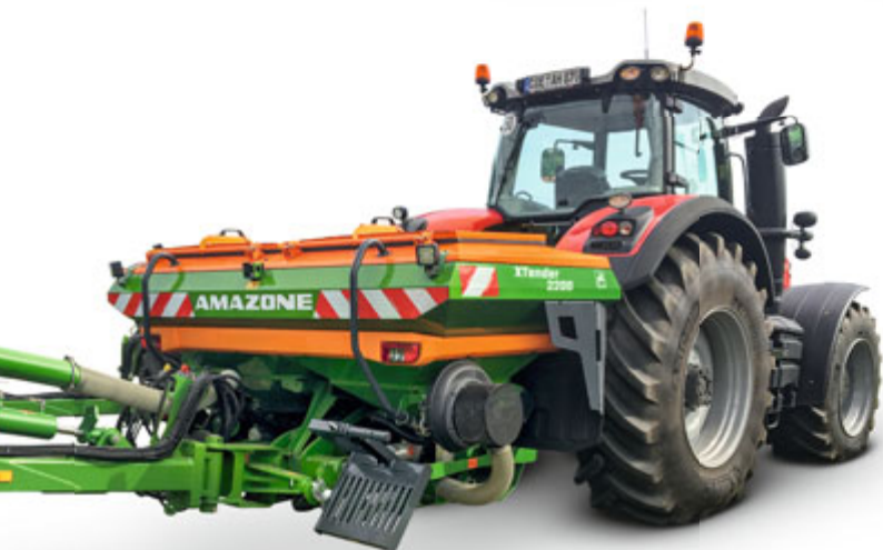
Zawieszany zbiornik XTender 2200 o pojemności 2.200 l
