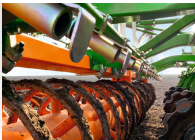
Talerz odbojowy do rozpraszania materiału siewnego
