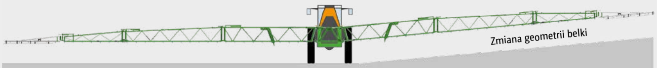
Zmiana geometrii belki (za pomocą rozkładania Flex 2)
