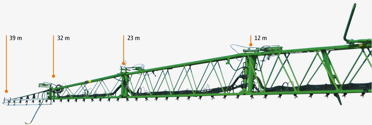
Belka polowa Super-L2 o szerokości 39 m, z możliwością redukcji do 32 m, 23 m i 12 m
