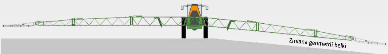
Zmiana geometrii belki (za pomocą rozkładania Flex 2 w połączeniu z ContourControl)
