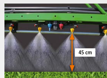
Rozpylacz 80°: Rozstaw rozpylaczy 25 cm
