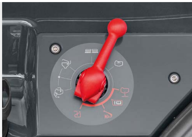
Samodzielnie zaprojektowany 7-drożny zawór ciśnieniowy
