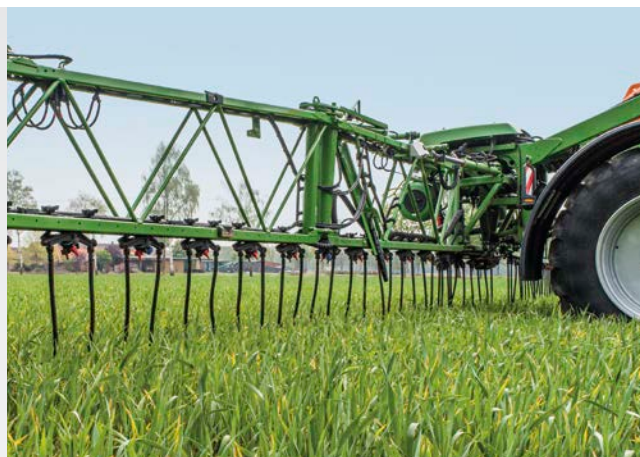
Wyposażenie w węże wlezione z poczwórnym korpusem AmaSwitch i zestawem przedłużeń na belce polowej Super-L2
