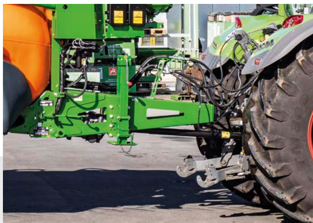
Zawieszenie górne ze sprzęgiem kulowym i mechaniczną podporą
