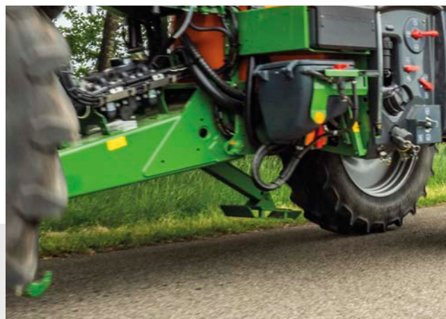
Zawieszenie dolne z podporą hydrauliczną
