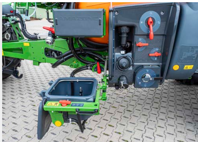
SmartCenter po lewej stronie maszyny z rozłożonym rozwadniaczem
