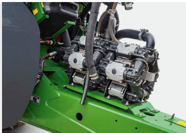
System podwójnej pompy modelu UX 11201 Super osiąga wydajności ssania do 900 l/min
