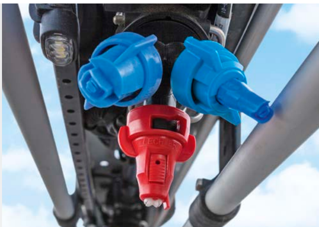
✓ Elektryczne oświetlenie LED każdego rozpylacza AmaSwitch
