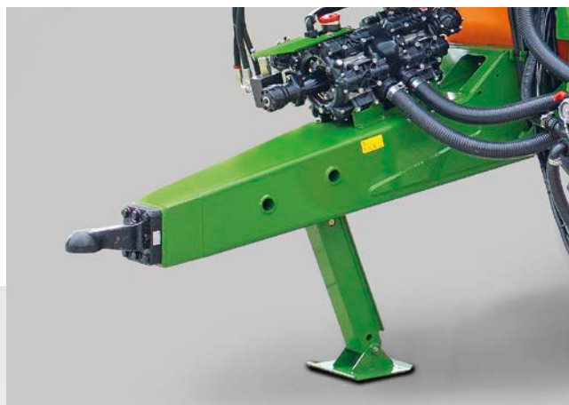
Zaczep dolny ze sprzęgiem kulowym K80 i podporą hydrauliczną
