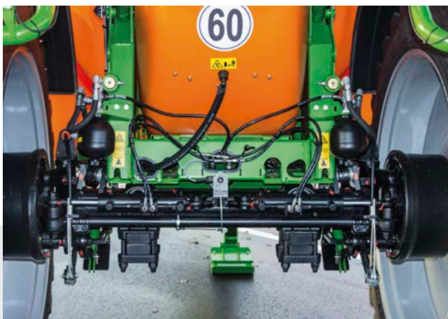
Hydrauliczno-pneumatyczne zawieszenie osi z osią skrętną AutoTrail
