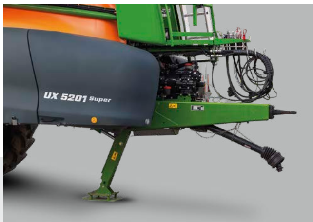
Zaczep górny z uchem i hydrauliczną podporą
