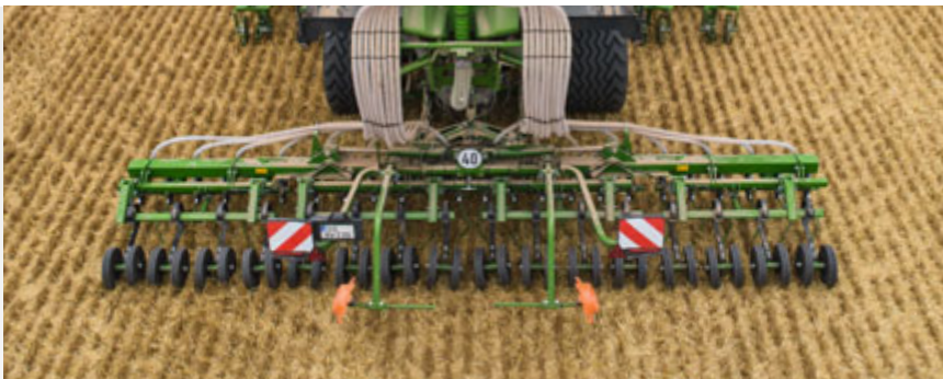
Znacznik przedwzschodowy w modelu Primera DMC 6000-2C
