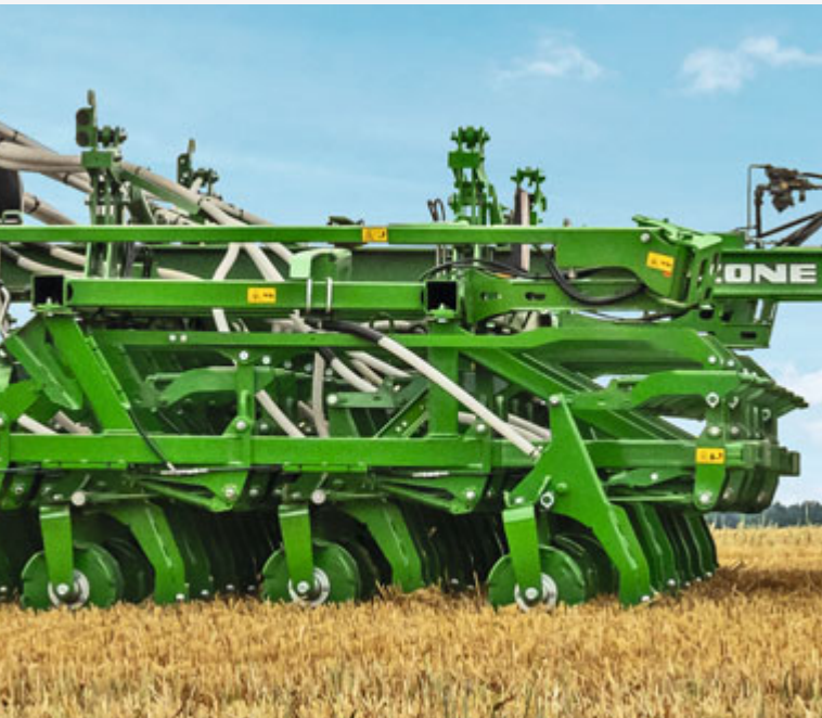
Zawieszenie redlic dłutowych na równoległoboku
