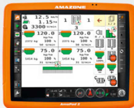
AMAZONE AmaPad 2 z dużym ekranem dotykowym o rozmiarze 12,1 cali
