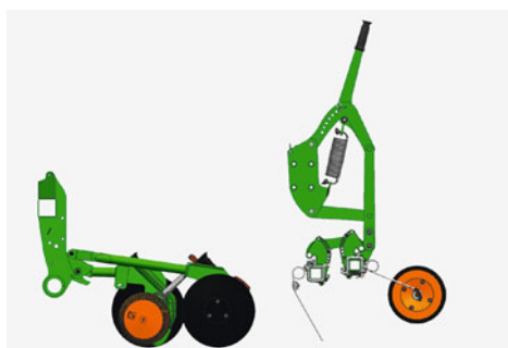
Zagarniacz rolkowy nieaktywny: zęby nadal zakrywają nasiona glebą.
