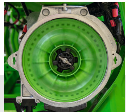
Tarcza rozdzielająca w trakcie pracy (bez pokrywy)
