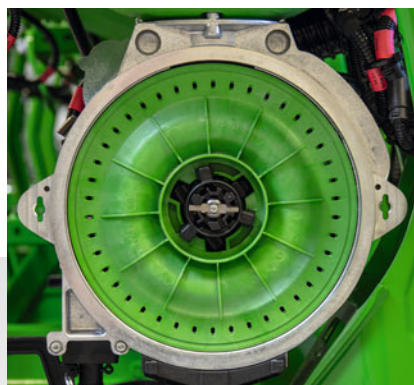
Zamontowana tarcza rozdzielająca w stanie spoczynku
