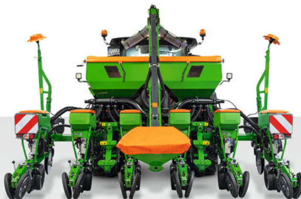
Siewnik Precea 4500-2CC z regulowaną ramą teleskopową przy pełnej szerokości roboczej
