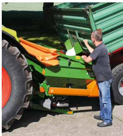
Napełnianie z wywrotki
