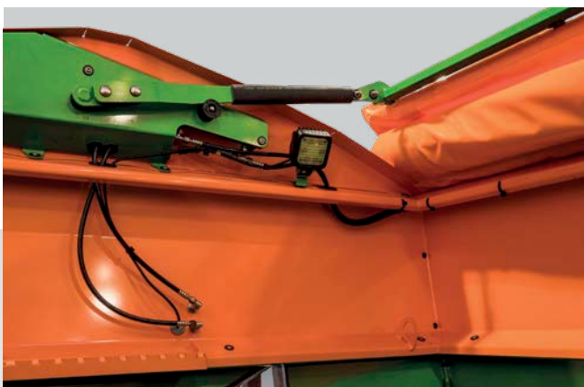
Oświetlenie robocze we wnętrzu zbiornika
