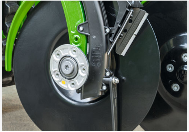
Zgarniacz wewnętrzny z utwardzanego metalu (wyposażenie specjalne)
