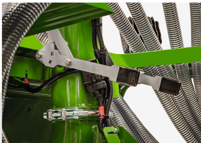
Mechaniczne rozłączanie połówkowe (załączone)
